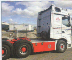
2653 6x4 er specifiert til kørsel med en 4-akset trailer med baglip og 56 tons totalvægt.
